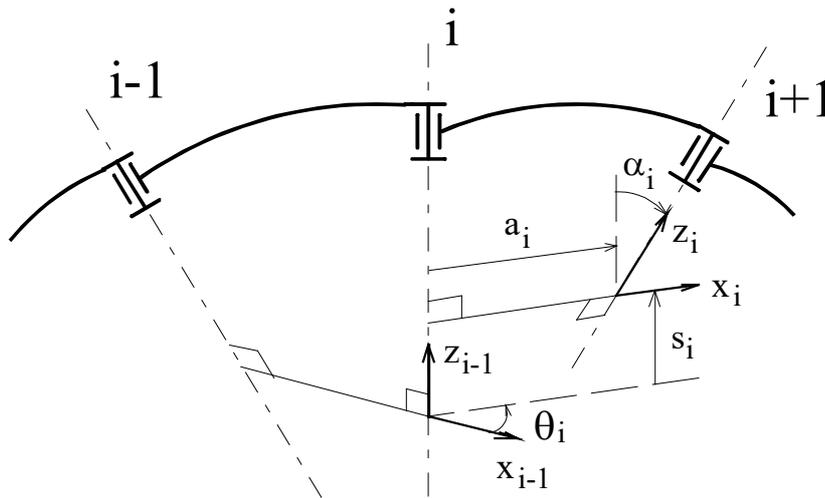
**Bild 5.1: Gelenkparameter bei Denavit und Hartenberg**
